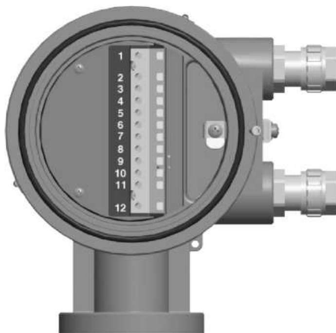
Рисунок 2 – Клеммы подключения преобразователя сигналов WMC-10
