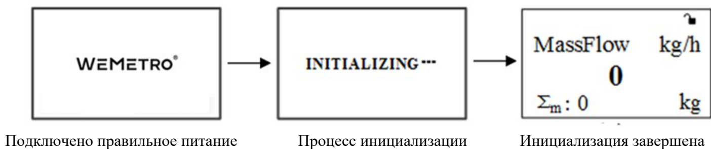
Рисунок 11 – Последовательность инициализации (отображение на дисплее)
