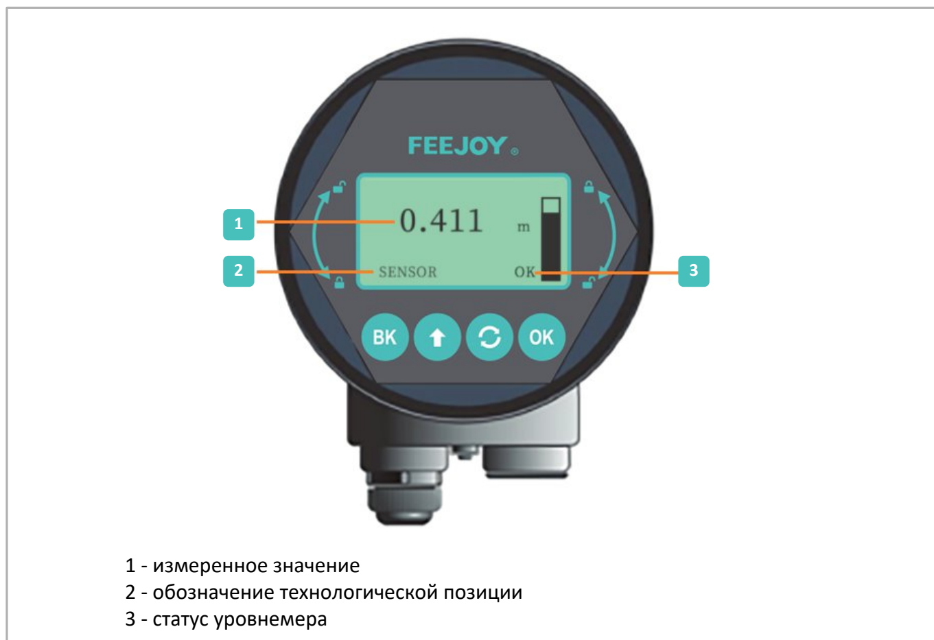
Рисунок 25 – Основной режим работы уровнемера
