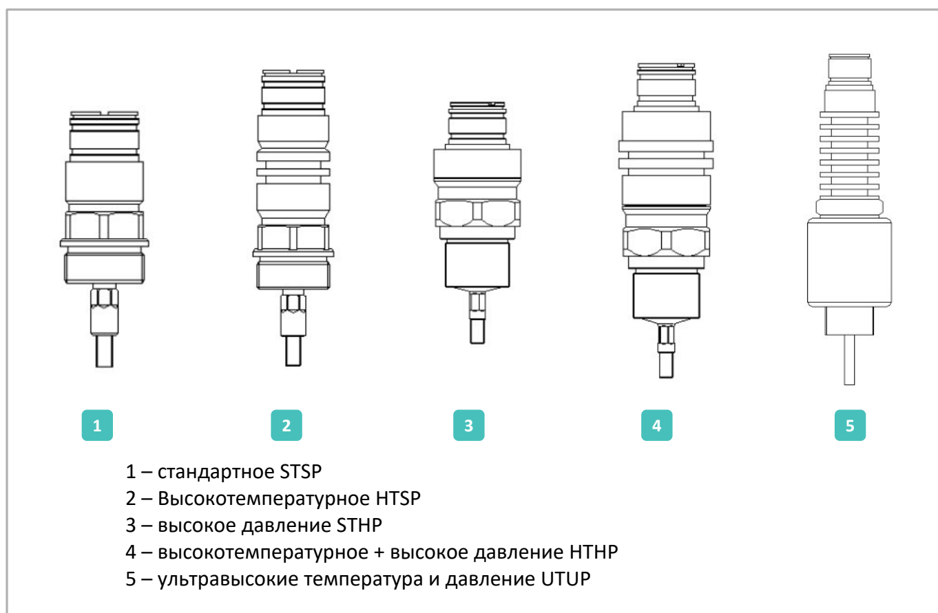
Рисунок 3 – Различные конструкции технологического присоединения
