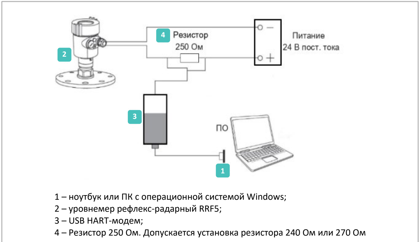
Рисунок 21 – Настройка уровнемера при помощи внешнего ПО
