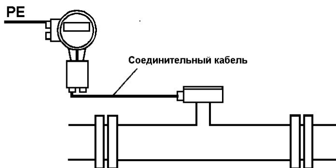
Рисунок 10 - Заземление расходомеров с раздельной компоновкой UFM 3030 F посредством защитного проводника кабеля электропитания
