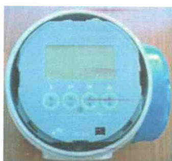
Рисунок 4 – Дисплей преобразователя сигналов IFC300 C/F. Защита от несанкционированного доступа
