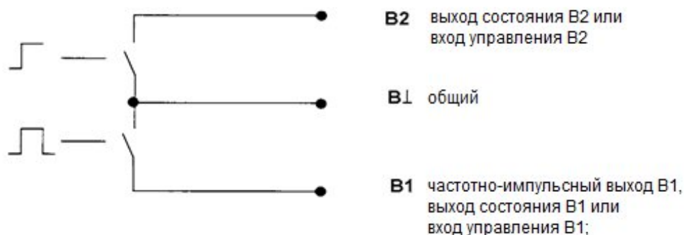
Рисунок 27 – Цепи частотно-импульсного выхода
