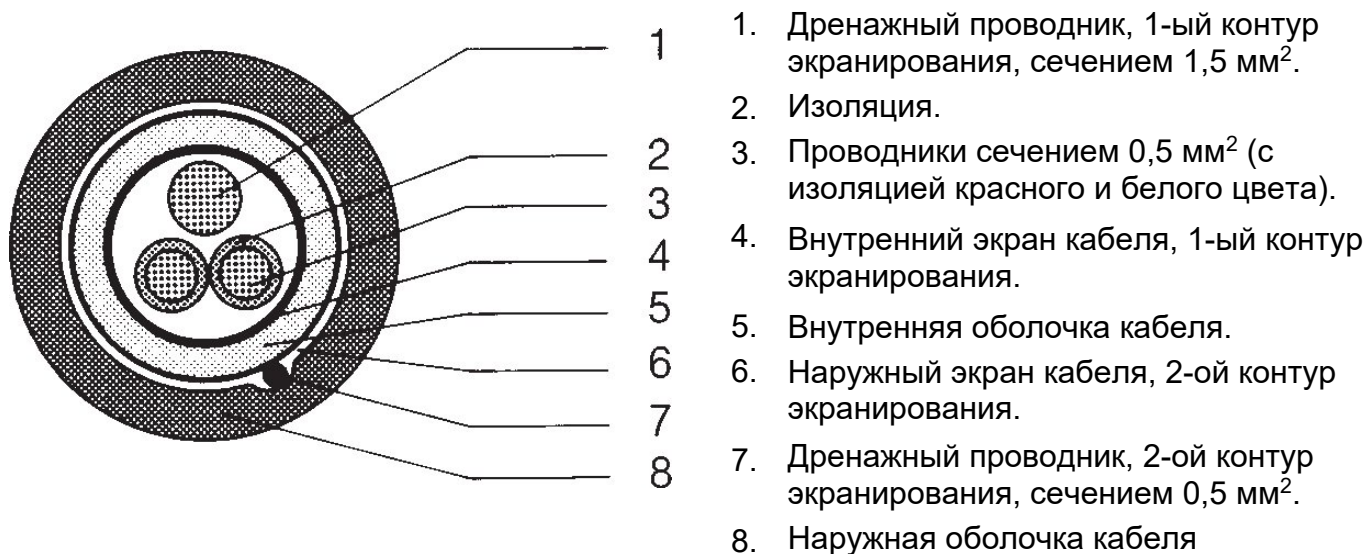
Рисунок 19 – Конструкция сигнального кабеля А (тип DS)
