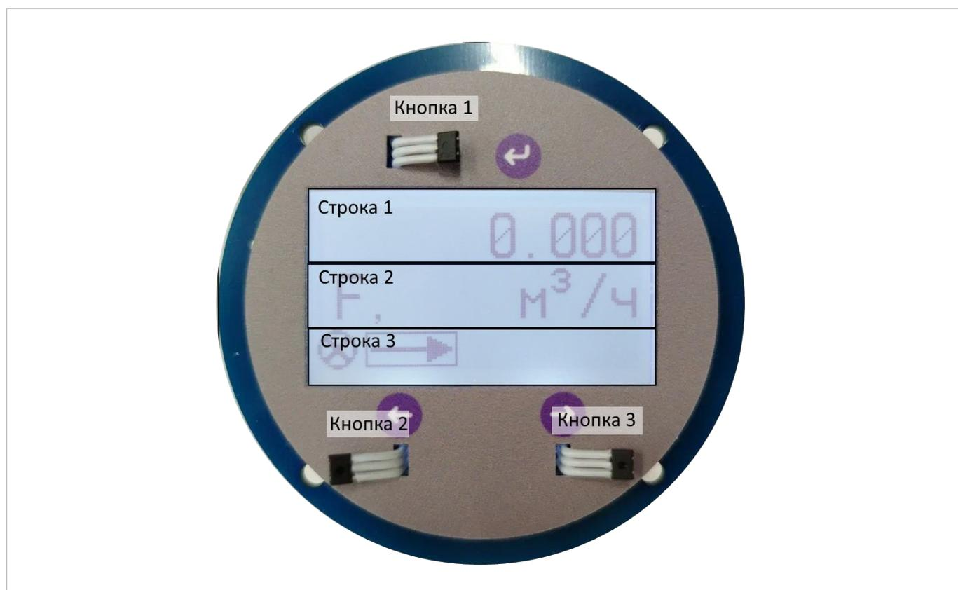
Рисунок 32 – Дисплейный модуль
