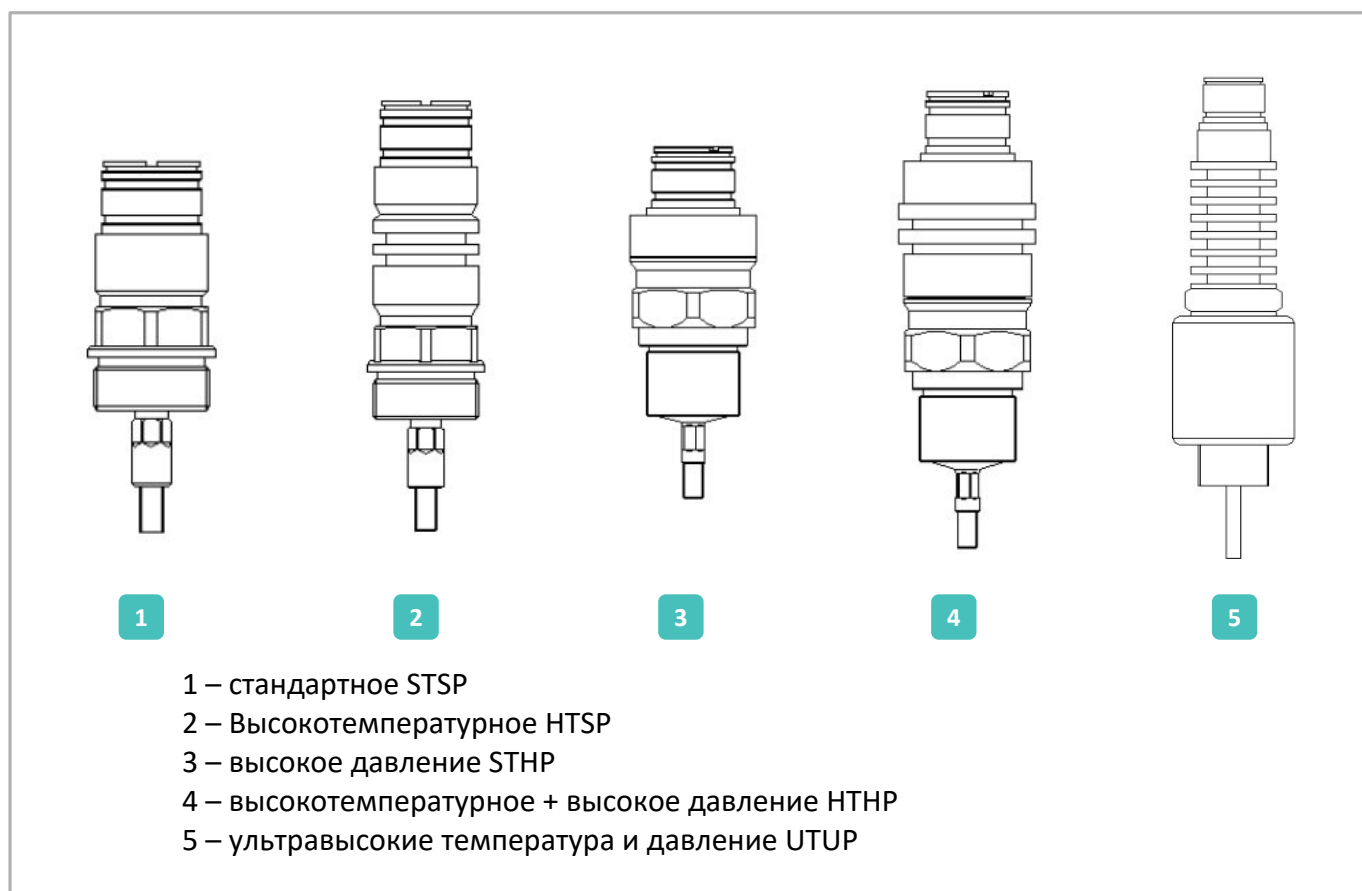
Рисунок 3 – Различные конструкции технологического присоединения
