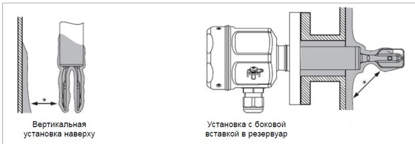
Рисунок 19 – Установка в случае налипания материала на стенки резервуара
