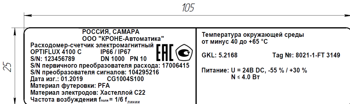
Рисунок 10 – Табличка на преобразователе сигналов IFC 100 не взрывозащищенного расходомера
