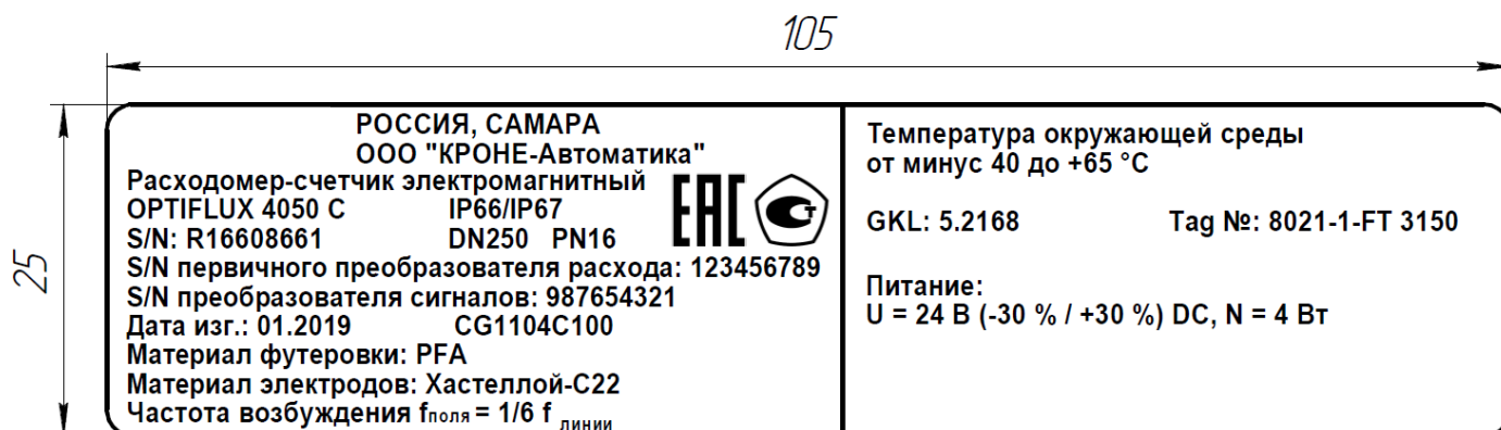
Рисунок 6а – Пример таблички на преобразователе сигналов
